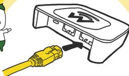
機器背面のWANポートにLANケーブルのもう片方を挿す!
